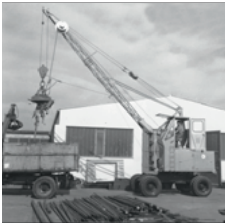
1962: Seilbetriebener S833 mit erhöhter Fahrerkabine
