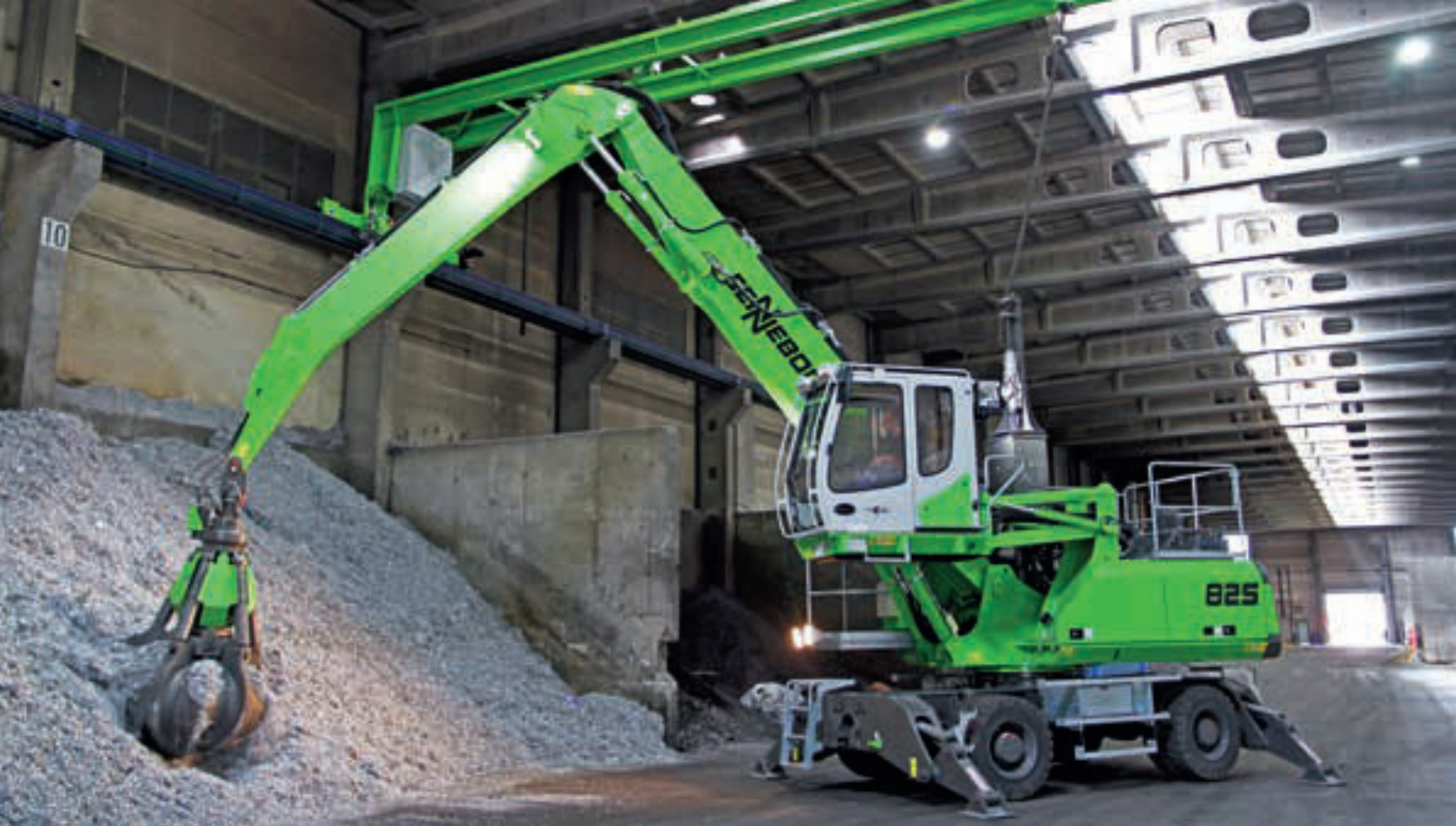
825 M Elektro - Schrottschlag in der Halle mit Deckenstromversorgung; Deutschland
