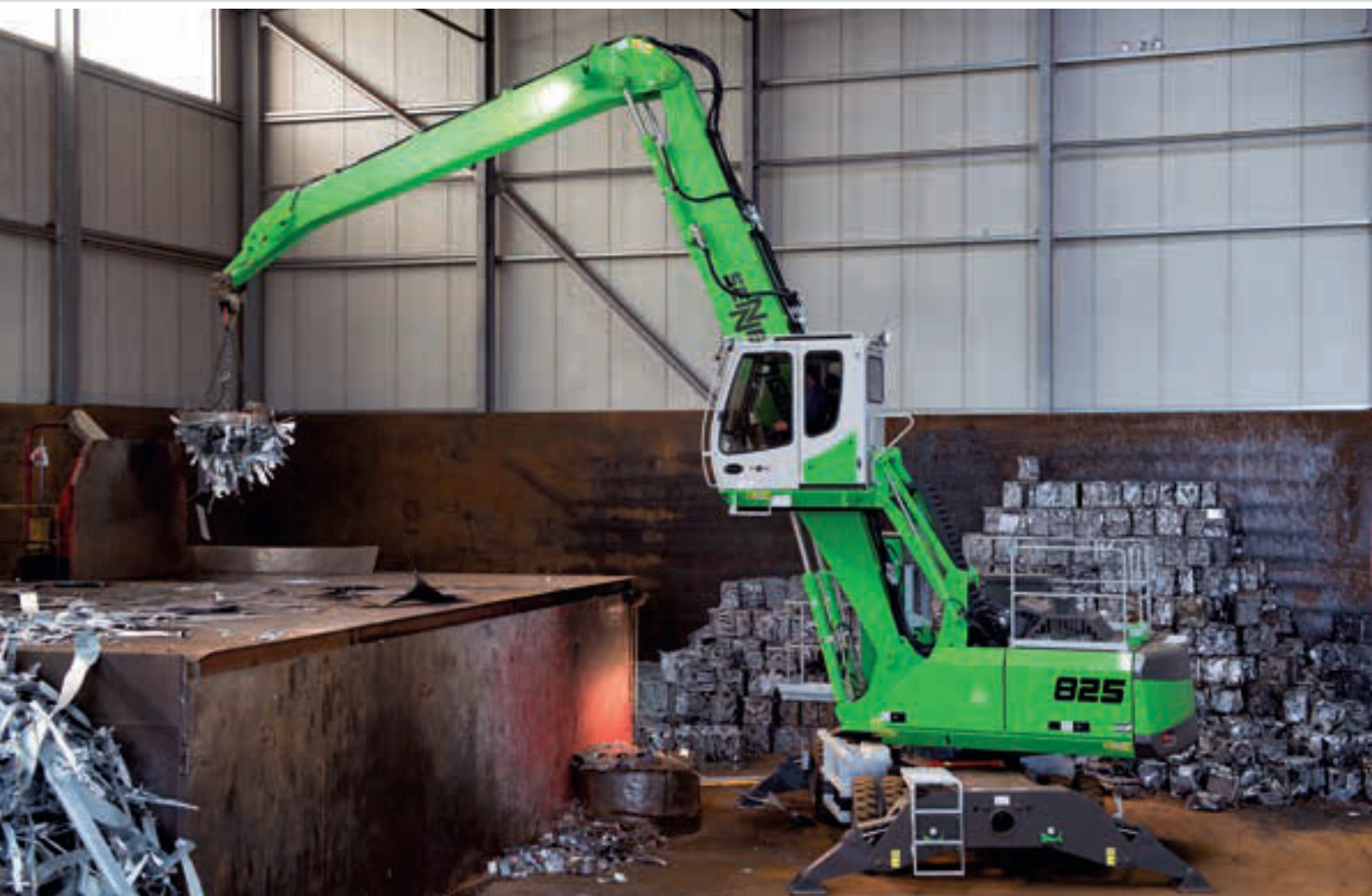
18 825 M - Schrottschlag mit Magnetplatte; Deutschland
