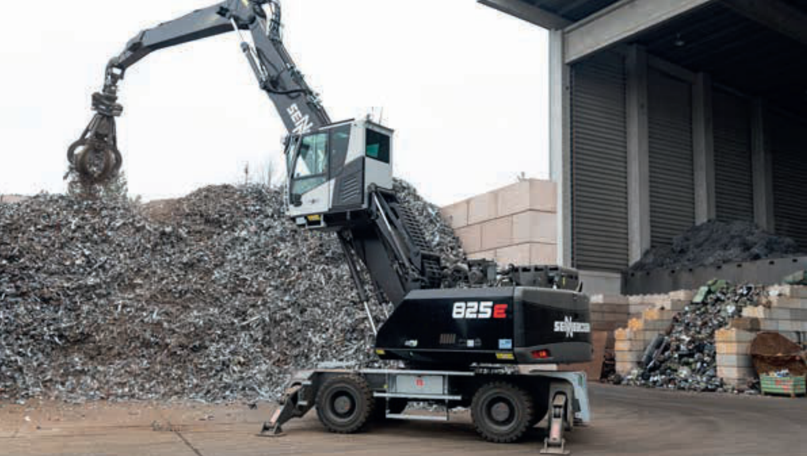
825 M - Schrottschlag mit Mehrschalengreifer; Deutschland
