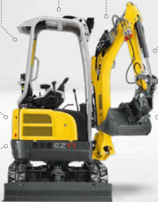
**Bis zu 4 Zusatzsteuerkreise** für den einfachen Betrieb von Anbauwerkzeugen wie Schwenklöffel oder Abbruchhammer – optional mit Vorbereitung für den hydraulischen Schnellwechsel
