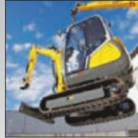
**2 Hebeösen** für leichtes Versetzen der gesamten Maschine
