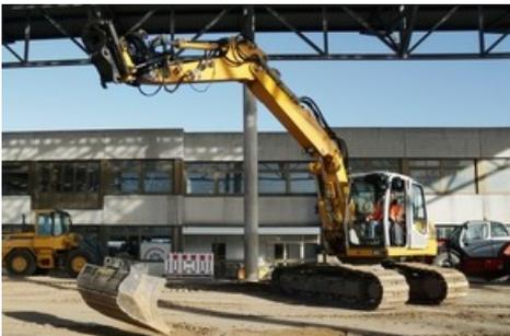
*Werden Schnellwechsel-Einrichtungen für Baumaschinen nicht korrekt verriegelt, können Anbaugeräte plötzlich vom Ausleger fallen. Weiterer Text über ots und [www.presseportal.de/nr/60172](http://www.presseportal.de/nr/60172) / Die Verwendung dieses Bildes ist für redaktionelle Zwecke honorarfrei. Veröffentlichung bitte unter Quellenangabe: "obs/Berufsgenossenschaft der Bauwirtschaft/Volker Münch, BG BAU"*
