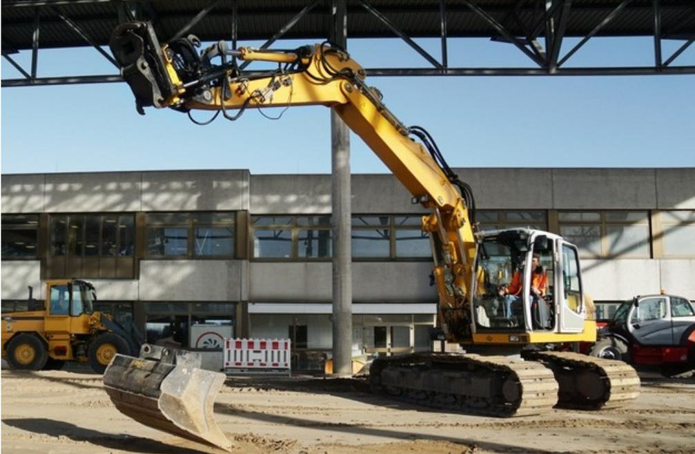
*Berlin (ots)* - Schnellwechsel-Einrichtungen für Baumaschinen erlauben es, verschiedene Anbaugeräte wie Tieföffel, Rohrgreifer oder Abbruchwerkzeuge in wenigen Augenblicken auszutauschen. So praktisch sie sind, falsch verwendet können sie tödliche Gefahren bergen. Zwischen 2010 und 2016 geschahen 45 zumeist schwere und tödliche Unfälle. Das hat die Berufsgenossenschaft der Bauwirtschaft (BG BAU) am 12. April 2018 mitgeteilt.
