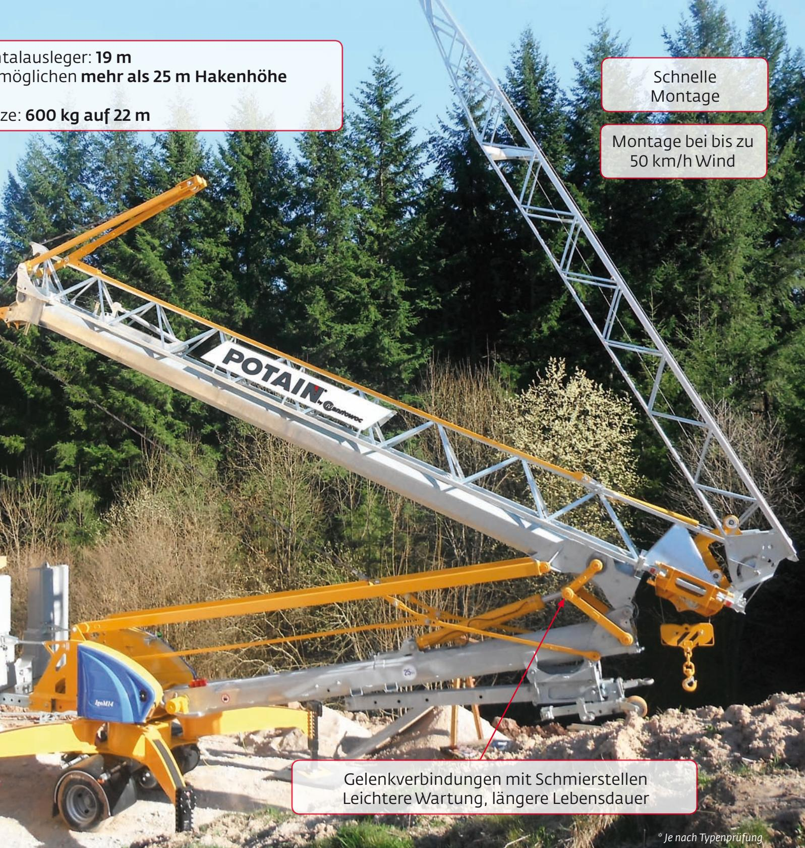
Gelenkverbindungen mit Schmierstellen
