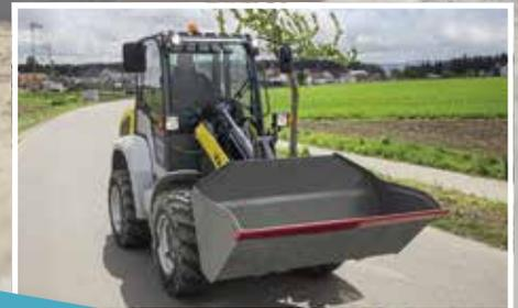
Das Besondere: Die vordere Ladungsicherung erfolgt über die Schnellwechselladung des Radladers.
