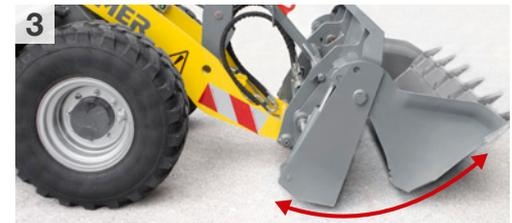
Smart Attach - Sekundenschneller Anbaugerätewechsel
